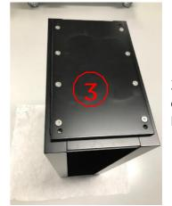
Zweite Seitenwange 1 mit der Bodenplatte 3 und der Kopfplatte 2 verschrauben
