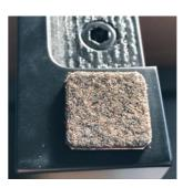
Beiliegenden Filz als Unterlage für die Lautsprecher auf die Kopfplatte kleben.
