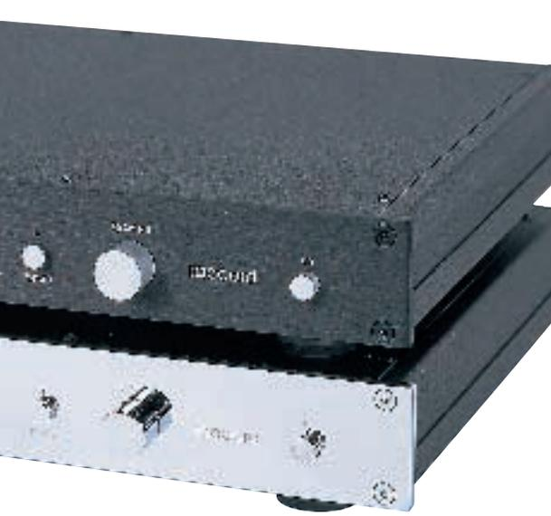
Die optional erhältliche Aktivweiche regelt die Grenzfrequenz der Baßmodule und entlastet die Satelliten von tiefen Tönen. Der durchgehend symmetrische Aufbau und diskret aufgebaute Ausgangsstufen machen Raccord hochwertigster Elektronik ebenbürtig.
