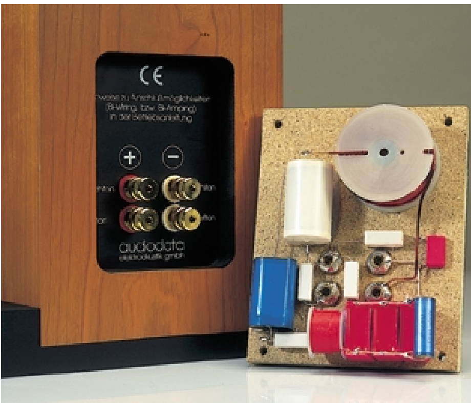
Dies ist nur die Grundversion der frei verdrahteten Filou-Frequenzweiche, denn abhängig von den voraus erfaßten Daten der eingebauten Treiber wird jede Weiche einzeln abgestimmt
