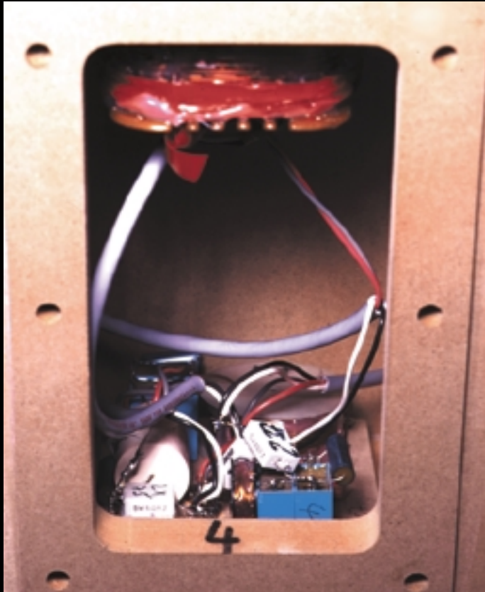
Direkt am Anschlußfeld sitzt die Weiche in einem separaten Gehäuseteil, damit kein Schalldruck zu Induktionen in den Spulen führen kann
