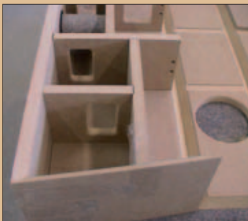
Hochpräzise gefräst und aufwendig versteift: Das MDF-Gehäuse der Ambiance glänzt mit sauberer Verarbeitung und durchdachtem Aufbau.
